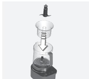
3. **Montáž malej pracovnej nádoby a malého multifunkčného noža/noža na sekanie:** Malú pracovnú nádobu umiestnite do veľkej nádoby. Ak je malá nádoba umiestnená nesprávne, veko nie je možné zatvoriť. Malý multifunkčný nôž namontujte jeho pevným zatlačením na miesto.
