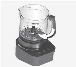
2. **Placez la base moteur sur une surface plane et sèche.** Placez le bol sur la base moteur (le bol est installé correctement sur la base uniquement lorsque la poignée est positionnée à droite). Bloquez le bol en tournant sa poignée dans le sens des aiguilles d'une montre.
