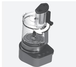
3. **Placez le couvercle sur le bol.** Le symbole ▼ présent sur le couvercle doit être aligné avec celui ▲ présent sur la poignée. Tournez le couvercle dans le sens des aiguilles d'une montre pour le verrouiller. **Remarque :** Si le bol et le couvercle ne sont pas correctement assemblés, l'appareil ne fonctionnera pas.
