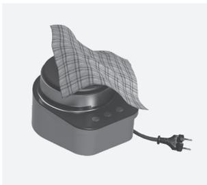
1. **Éteignez l'appareil**, débranchez la fiche de la prise électrique et attendez que les outils soient complètement arrêtés. Essuyez la base moteur à l'aide d'un chiffon humide.
