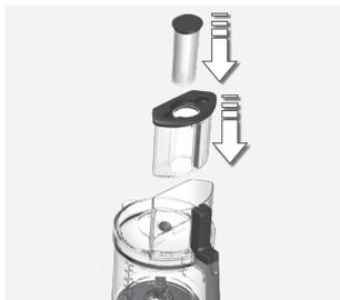
**4. K dispozícii sú dva rôzne typy nástavcov na zatláčanie do veka:** veľký (na veľkú zeleninu) a malý (napríklad na mrkvu alebo uhorky). Malý nástavec na zatláčanie umiestnite do väčšieho nástavca a následne veľký nástavec na zatláčanie umiestnite do plniaceho otvoru na veku nádoby. **Poznámka!** Spotrebič sa nespustí v prípade, ak nie je veľký nástavec na zatláčanie správne umiestnený do plniaceho otvoru.
